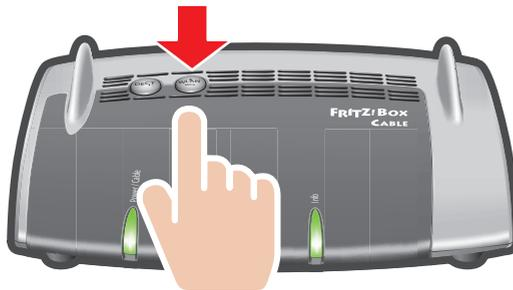
Die WLAN-Verbindung wird hergestellt.
