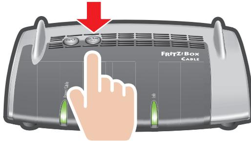
Die WLAN-Verbindung wird hergestellt.
