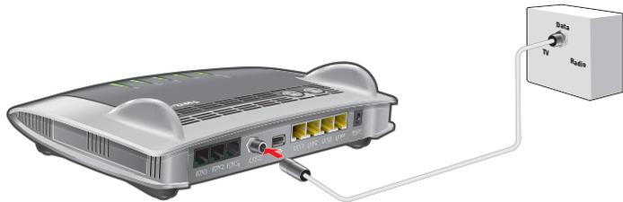
Am Kabelanschluss anschließen
