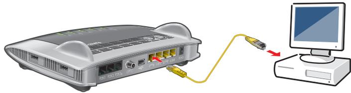
Anschluss eines Computers mit einem Netzwerkkabel
